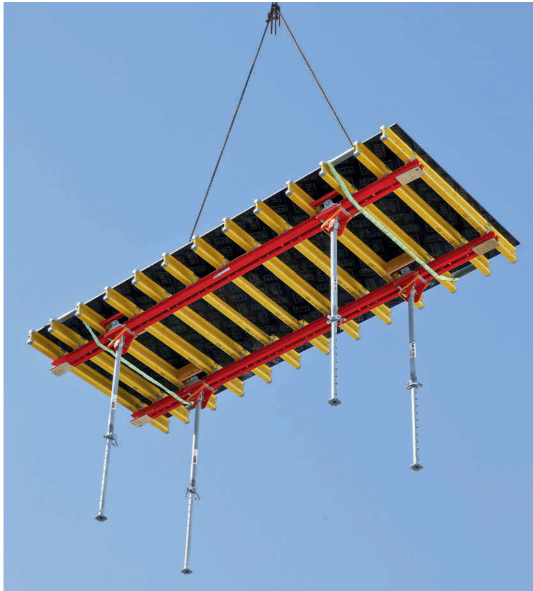
VARIODECK Stahlriegel Deckentisch in der Größe 2,50/2,65 x 6,00 m benötigt nur 4 Deckenstützen. Das entspricht maximal 4 m 2 Decke pro Stütze.
